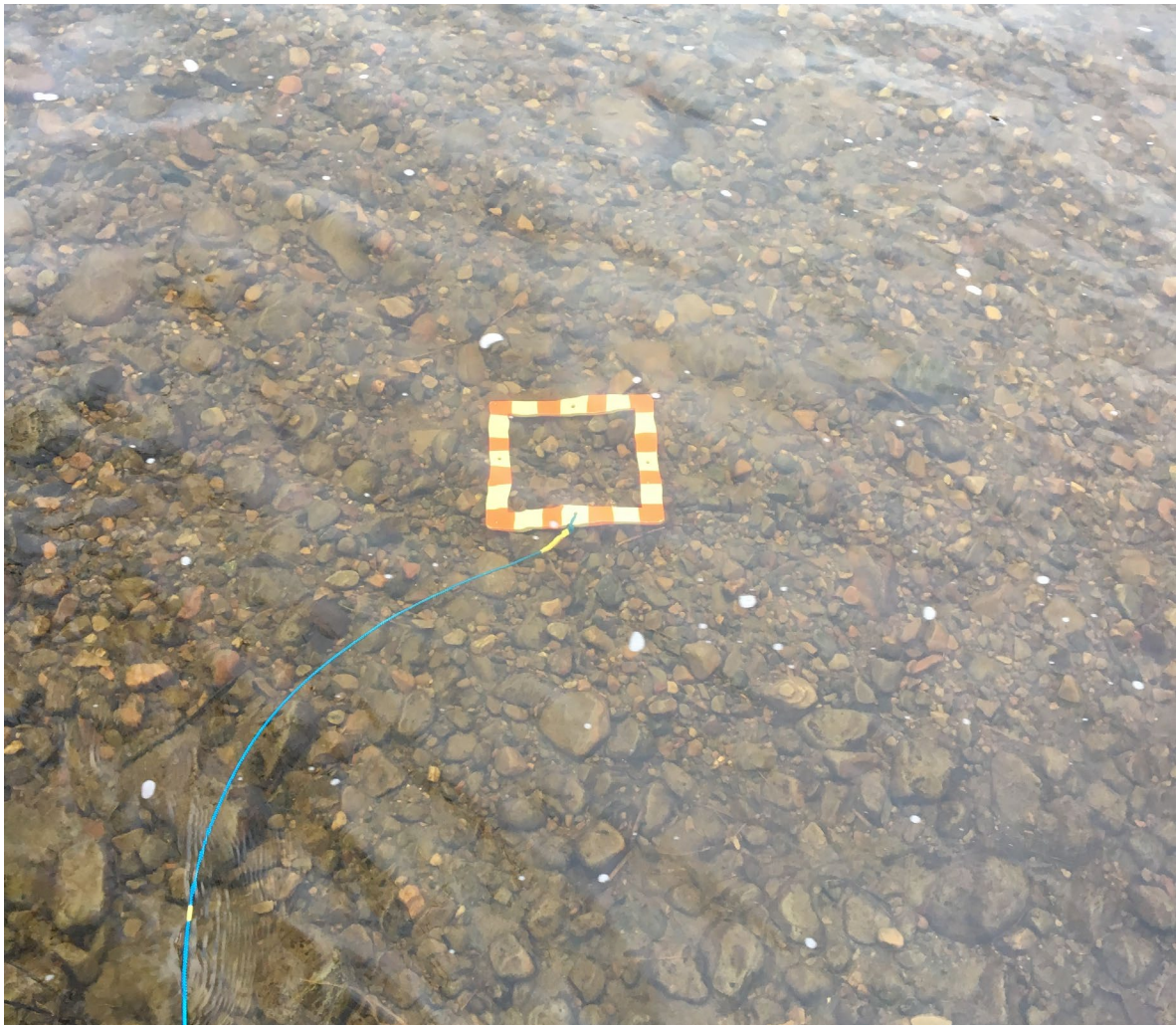
Figur 11 Eksempel på måling av substratstørrelse. Ruta har indre mål på 50 x 50 cm. Foto KM Myrvold, NINA.
