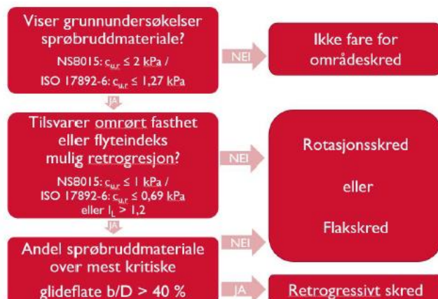
Figur 4.3 Flytskjema for vurdering av aktuell skredmekanisme
