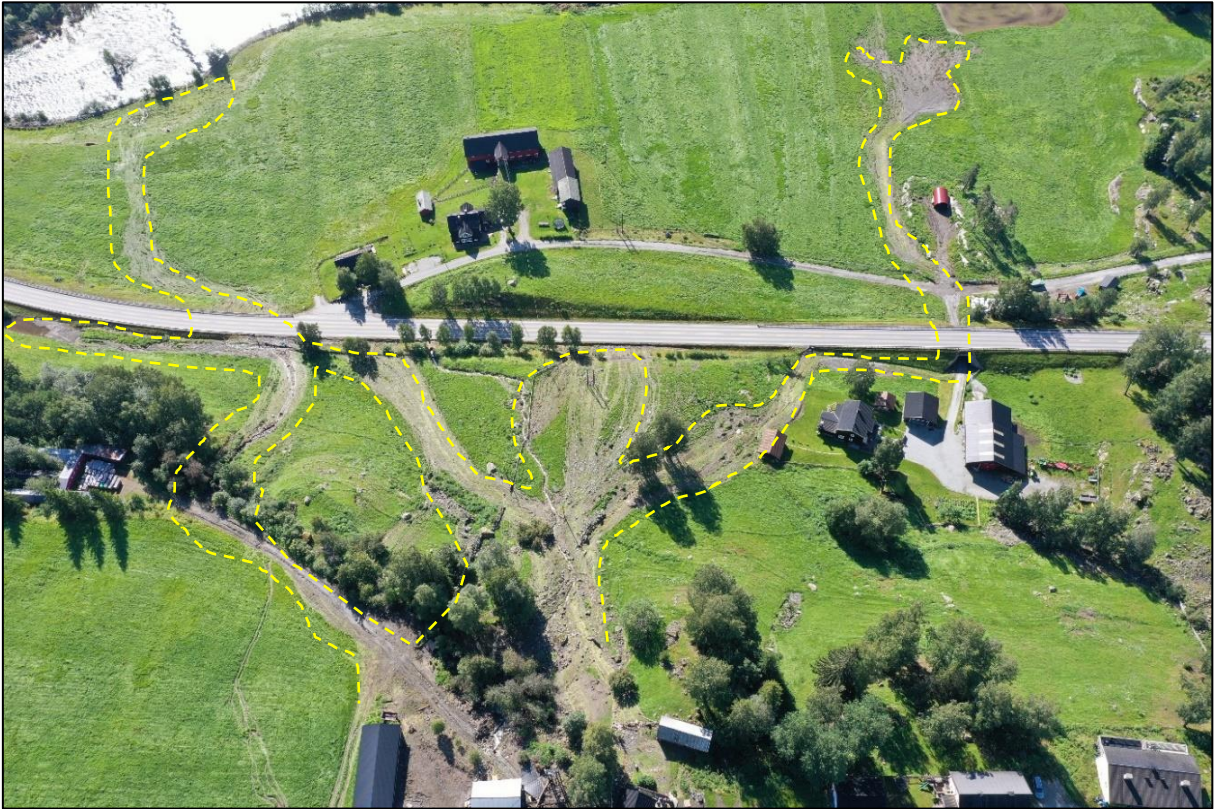
Figur 4: Bildet viser nedre del av skredløpet forbi Nordre Oppsata, og maksimalt utløp av vann/slam er omtrentlig inntegnet med gul stiplet linje. Hallingdalselva er så vidt synlig øverst i bildet. Vegen midt i bildet er Rv7.
