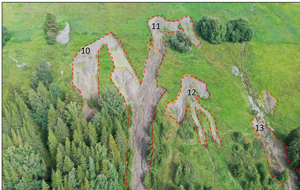
Figur 1: Bildet viser løснеområdene under «Hans» markert omtrentlig med rød stiplet linje, hvor skredet til venstre (ID 10) gikk ned til Sando barnehage. Eldre utglidninger er omtrentlig markert med oransje stiplet linje.
