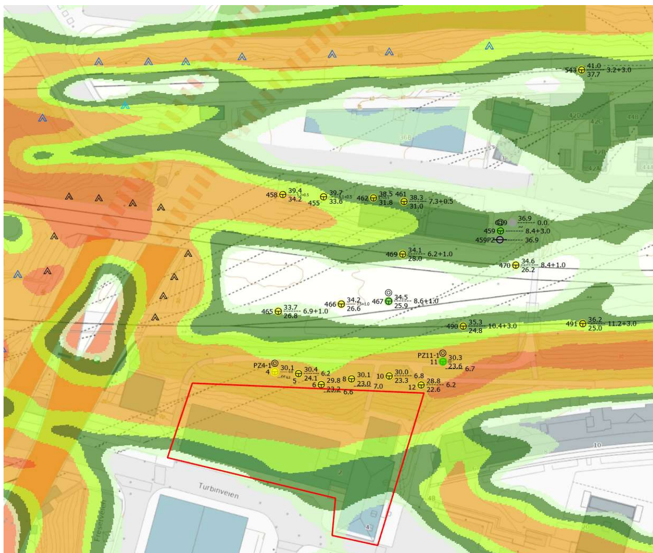
Figur 6-6: Utførte grunnundersøkelser [A] med markering av potensiale for sprøbruddmateriale. Gul = antatt ikke sprøbruddmateriale, Grønn = påvist ikke sprøbruddmateriale.
