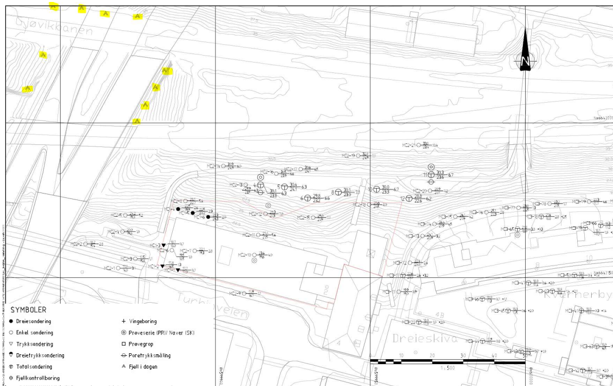
Figur 4-4: Utklipp fra borplan med sammenstilling av tidligere grunnundersøkelser, tegning 10216663-RIG-TEG-002 [A]. Innmålt berg i dagen er markert med gult.
