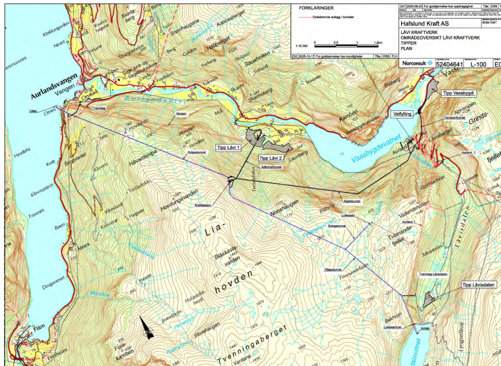
Figur 1: Kart for Låvi kraftverk; med inntak i Viddalsvatnet (nedst til høyre), tunnelsystem, utløp i Aurlandsfjorden (øverst til høyre), og med planlagde deponiområde. Kjelde: Norconsult; frå konsesjonssøknad for Låvi kraftverk.
