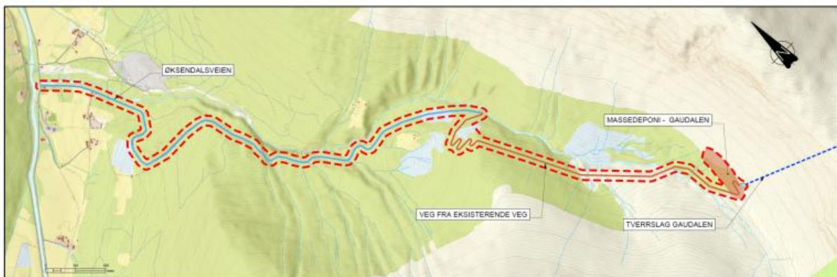
Figur 18. Prinsipptrase for ny midlertidig vei (brun strek), samt plassering av varig massedeponi og tverrslag i Gaudalen. Eksisterende vei fra fv. 6134 (Øksendalsvegen) i Øksendalen mot inntaket til Seterkraft kraftverk markert med blå strek. Inngrepsgrenser markert med rød stiplest strek. Utsnitt fra arealbruksplan i vedlegg 3.
