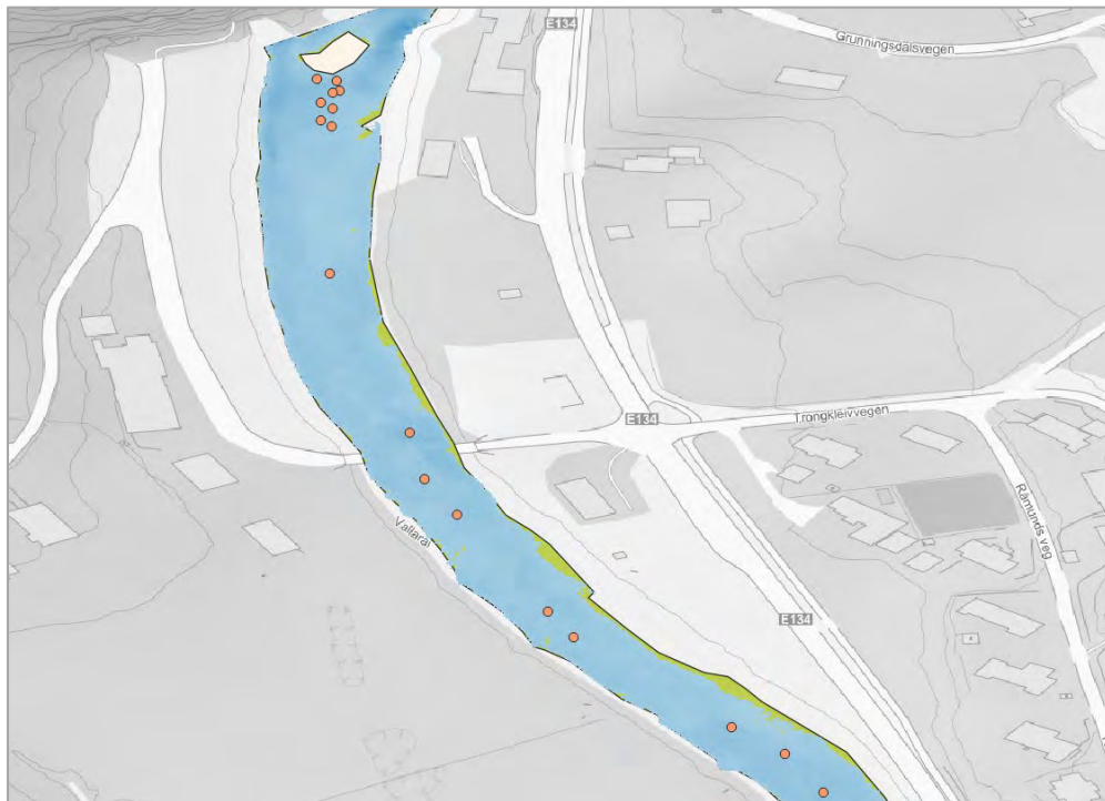
Figur 25 Vanndekket areal ved hydraulisk simulering (blå farge) 1,5 m 3 /s og flyfoto 3,2 m 3 /s (grønt underlag, synlig i kantene; kartlagt med drone og fly).
