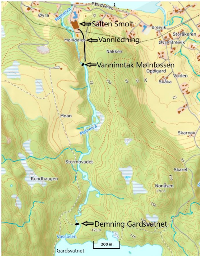
Figur 2. Viser detaljert hvor demning, vanninntak, vannledning og smoltanlegget er plassert. Minstevannføringsstrekning, som også er leveområde for elvemusling, er mellom demning Gardsvatnet og vanninntak Mølnfossen. Strekingen nedstrøms Mølnfossen er uten minstevannføring.
