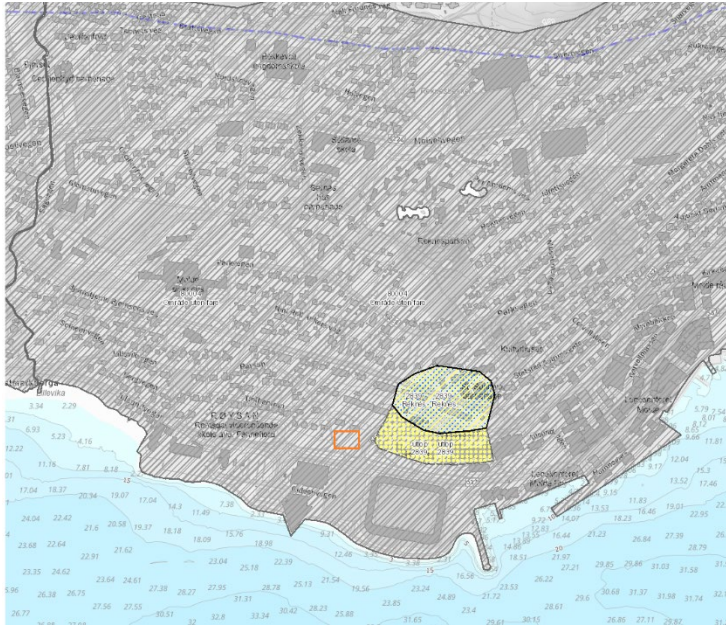
Figur 3-6 Vurdering av kvikkleirerisiko. Gult område med svart ytterlinje viser område der kvikkleire er påvist, med risikoklasse 3. Gult område med grå ytterlinje viser utløsningsområde for kvikkleire. Marin grense er markert med blå stiplet linje. Grå skravur viser område med kartlagt kvikkleiresone, vurdert som uten fare (kilde: NVE ). Tiltaksområdet er markert med oransje firkant.
