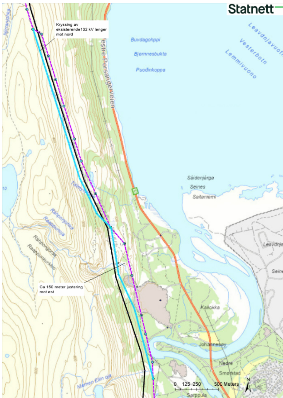
Figur 4. Kart som viser trasejustering ved Raahpa. Turkis strek viser konsesjonsgitt trasé og lilla trasé er den som nå er planlagt. Kartet er hentet fra Statnetts endringsøknad.
