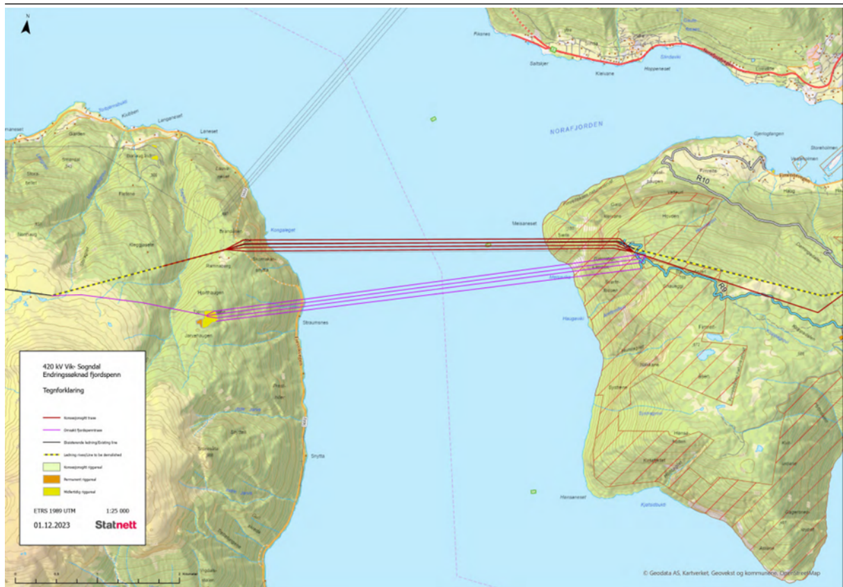
Kart 7: Endret fjordspenn over Sognefjorden. Nytt fjordspenn vist ved lilla streker lengst sør. Den tidligere konsesjonsgitte traseen vist ved mørkerøde streker lengst nord. Kilde: Statnetts konsesjonssøknad om endret fjordspenn 2023.
