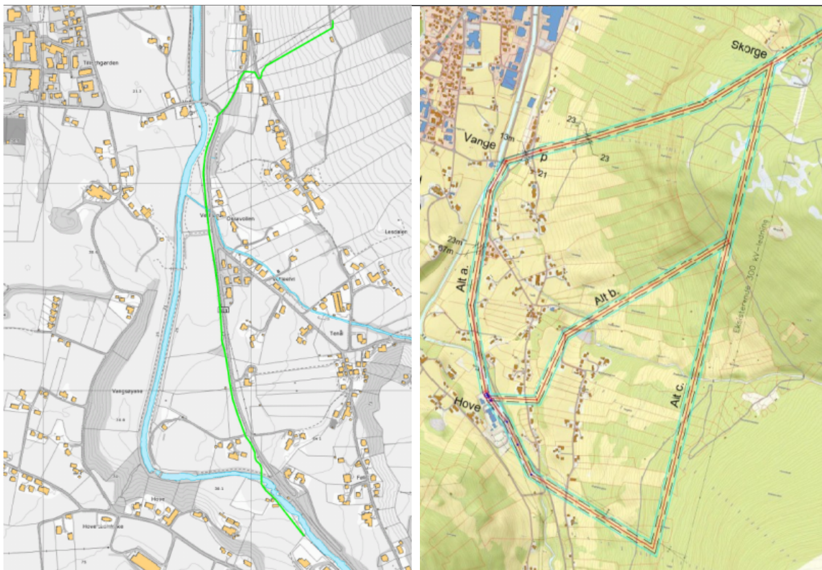
Kart 8: Kartet til venstre: Alternativ med kabel fra Seim til Hove transformatorstasjon. Kart til høyre: Alle omsøkte alternativer fra Skorge til Hove transformatorstasjon. Kilde: Konsesjonssøknaden til Sognekraft AS.
