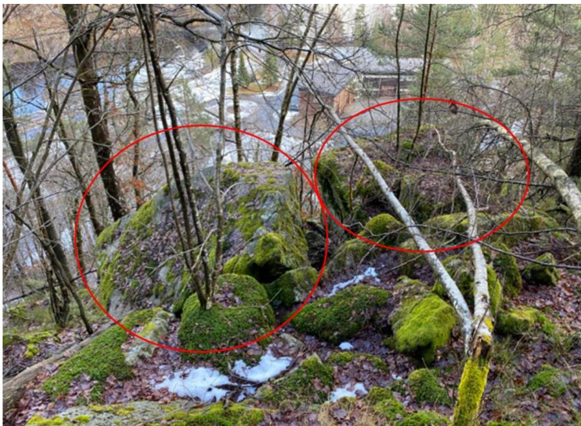
Figur 3 Observerte blokker ved punkt 1 med fare for remobilisering
