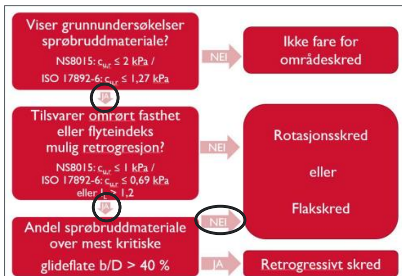
Figur 6-1: Vurdering av aktuelle skredmekanisme etter Figur 4.3 i NVEs veileder, ref. [2].
