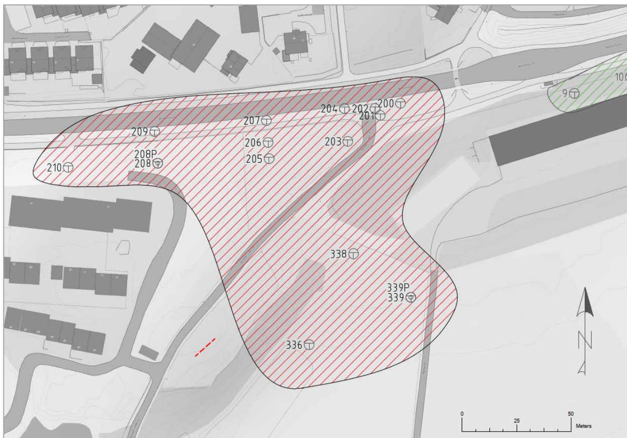
Figur 7: Oversikt over relevante grunnundersøkelser gjennomført i forbindelse med prosjektet Rv.509 Ragbakken øst.
