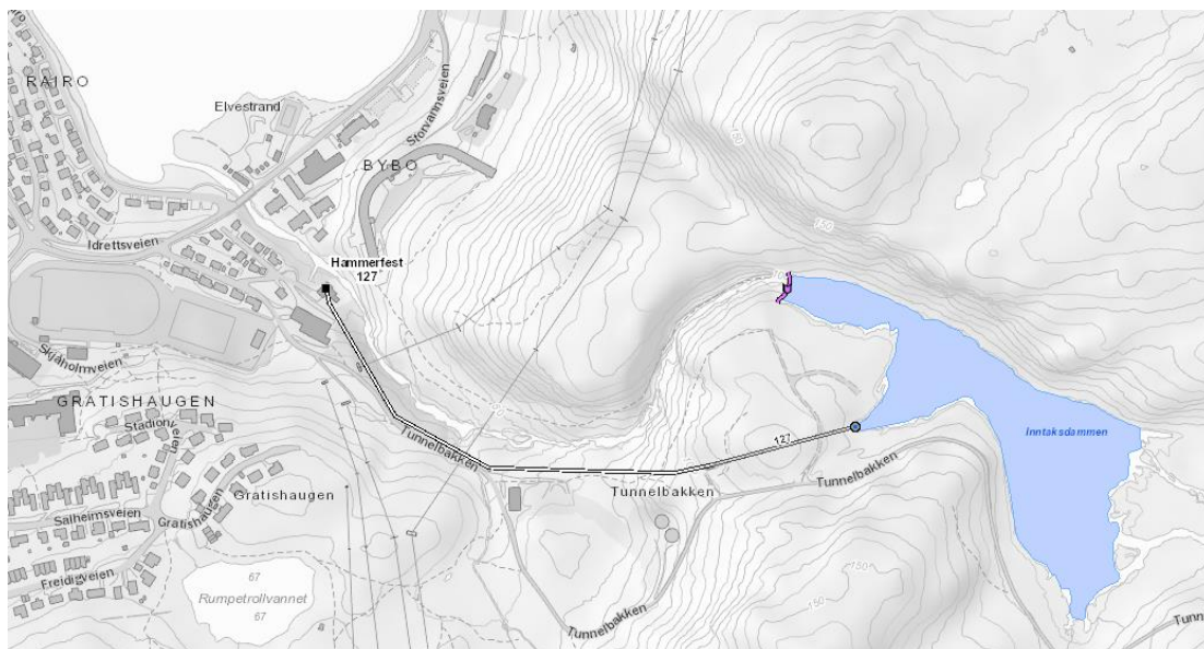
Figur 2. Hammerfest kraftverk, med inntak i Inntaksdammen og kraftverk om lag 200 meter oppstrøms Storvatnet. Det er ikke krav om minstevannføring, slik at den regulerte elvestrekningen jevnlig er tørrlagt. Figur er hentet fra NVE Atlas.
