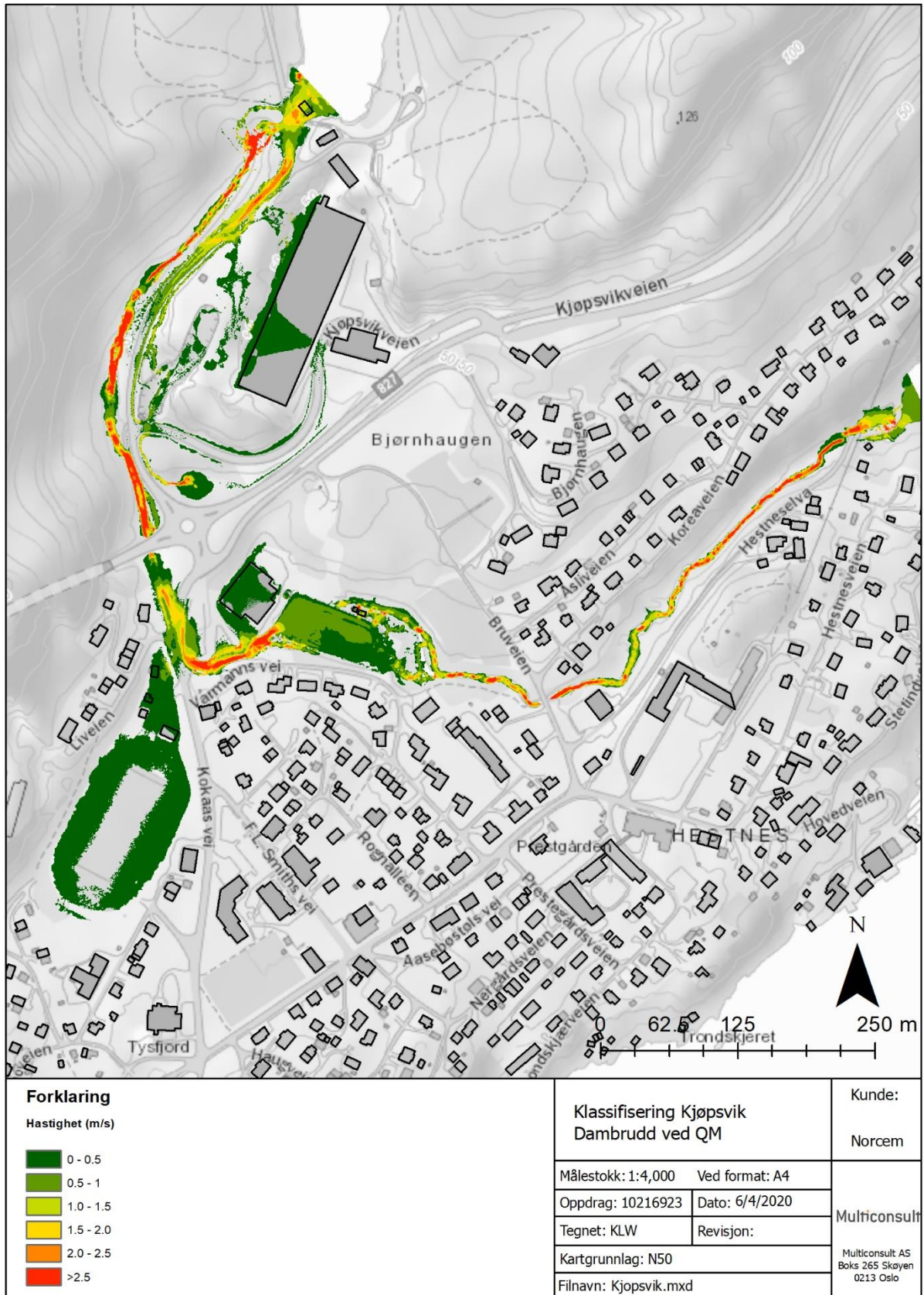
Figur 5-6. Vannhastigheter ved brudd ved middelflom.
