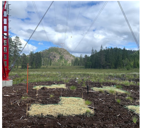
Figur 33: Forsøksfelt under mast for å teste metodikken. Torvmosefeltene ble dekket med halm og plastnett den første vekstsesongen.
