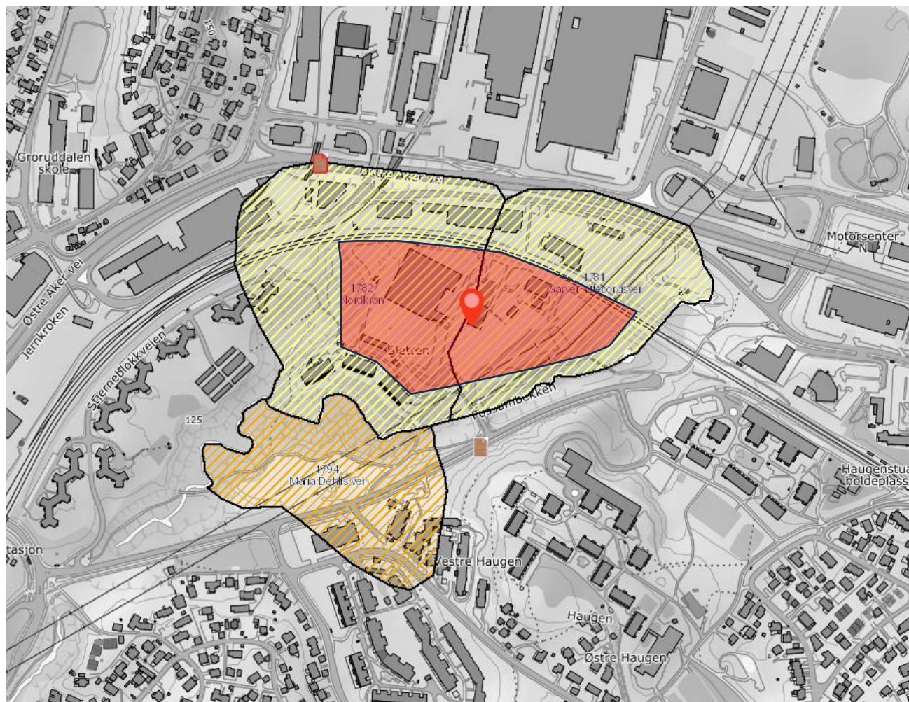
Figur 4: Oversikt over kartlagte kvikkleiresoner i området (kilde: NVE-Atlas). Eiendommen er markert i rødt
