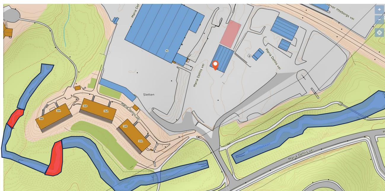
Figur 23: Sammenstilling vurdering av erosjon i Fossumbekken etter befarung fra RGT og DMR
