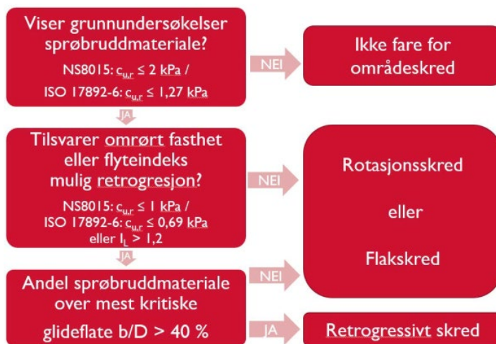
Figur 19 Flytskjema for vurdering av aktuell skredmekanisme [1].
