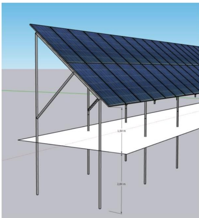
Figur 2-1: Eksempel på fundamentering av festesystem med peler.
