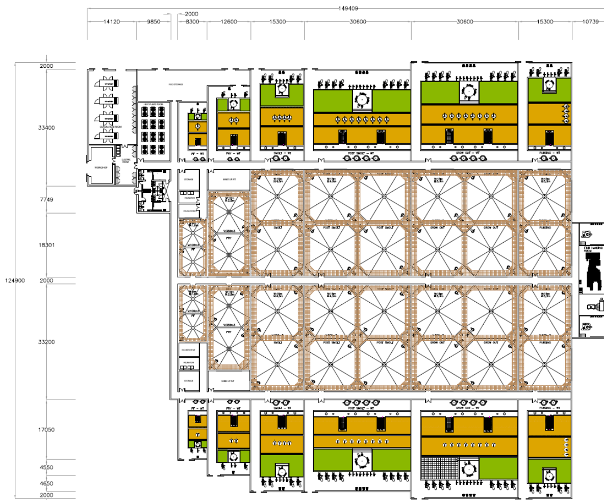
Figur 3. Planlagt resirkuleringsanlegg vil bestå av flere avdelinger, med hver sine renseanlegg og resirkuleringsenheter (her oransje og grønne, bestående av både mekaniske filtre og biofiltre). Anlegget vil bli omtrent 125 x 150 m stort, med tillegg for parkeringsplass og trase for inntaksledning og avøpsledning.
