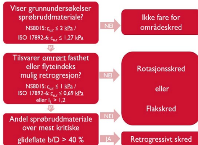
Figur 3-14: Flytskjema for skredmekanisme iht. NVE veileder nr. 1/2019 [3].
