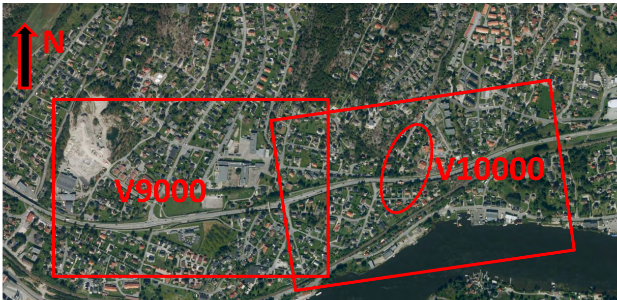
Figur 2-4: Oversiktskart som viser borplan V9000 og V10000. Området med utførte stabilitetsberegninger på borplan V10000 er vist med rød sirkel. Her er terrenget brattere enn 1:15, >5 m høydeforskjell og uten fjell i dagen.
