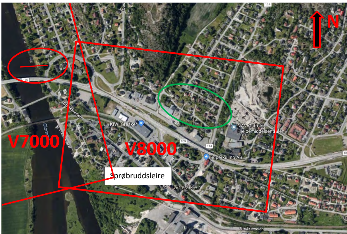
Figur 2-3 - Oversiktskart som viser borplan V8000. Området med helning brattere enn 1:15, >5 m høydeforskjell og uten fjell i dagen er markert med rød sirkel. Grønn sirkel viser skråningen på Greåker som er «friskmeldt» på grunn av massene.
