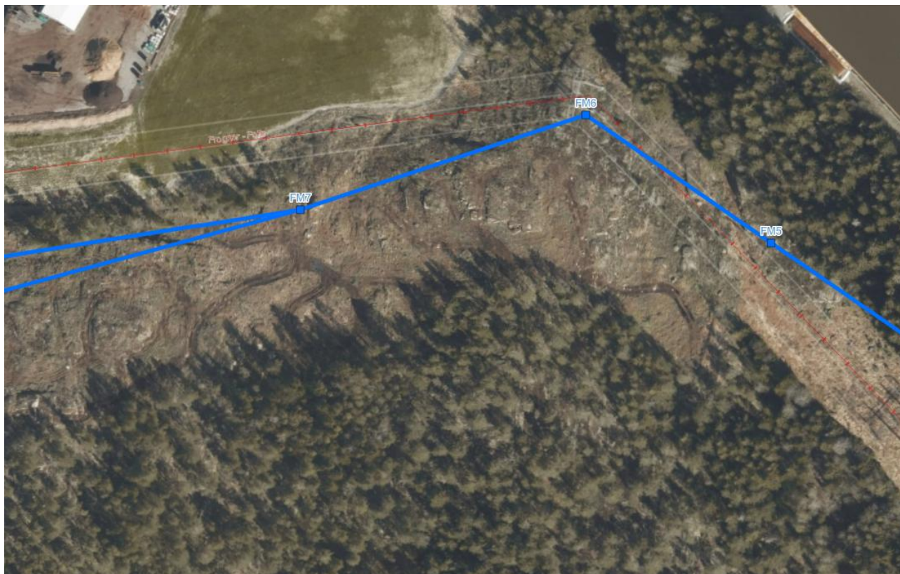
Figur 4-10: Fra mast 5 og inn til Liåsen stasjon er det behov for å fjerne noe sidevegetasjon.
