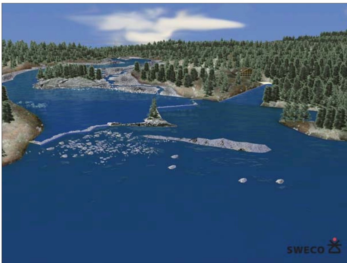
Figur 3-16. Perspektivskisse fra 3D modell. I skissen vises terskel, inntakskanal, dagbygg og redusert vannføring nedstrøms terskelen. Visualisering: Sweco.
