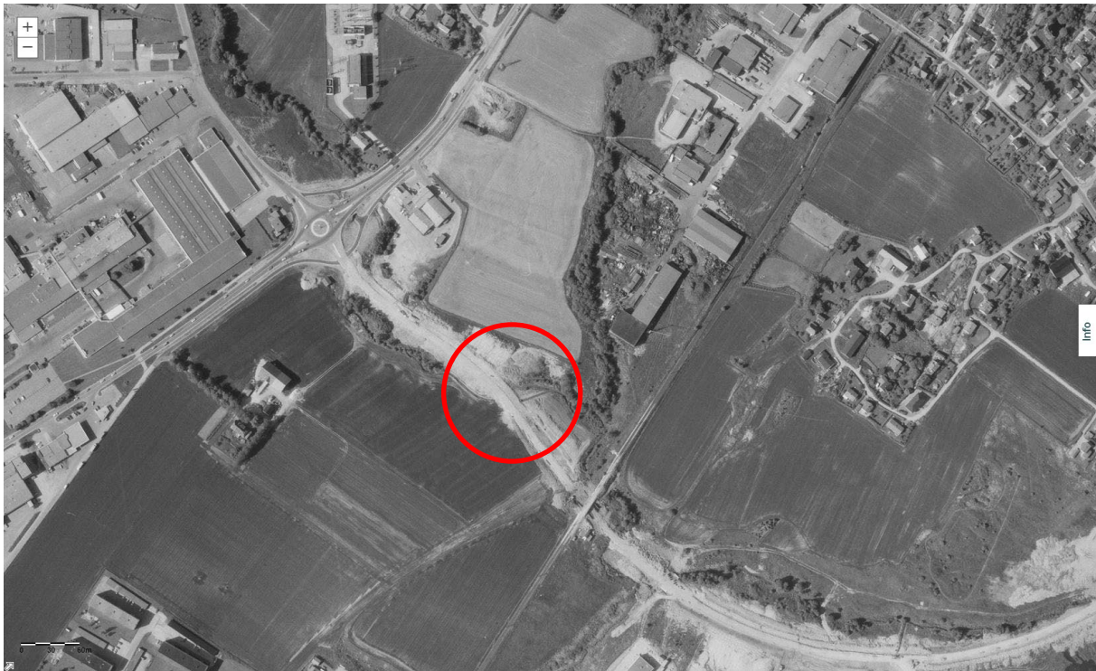
Figur 2-8: Flyfoto over området fra 1988. Rød ring angir strekke der bekken er lagt i rør under Evjebekkveien.
