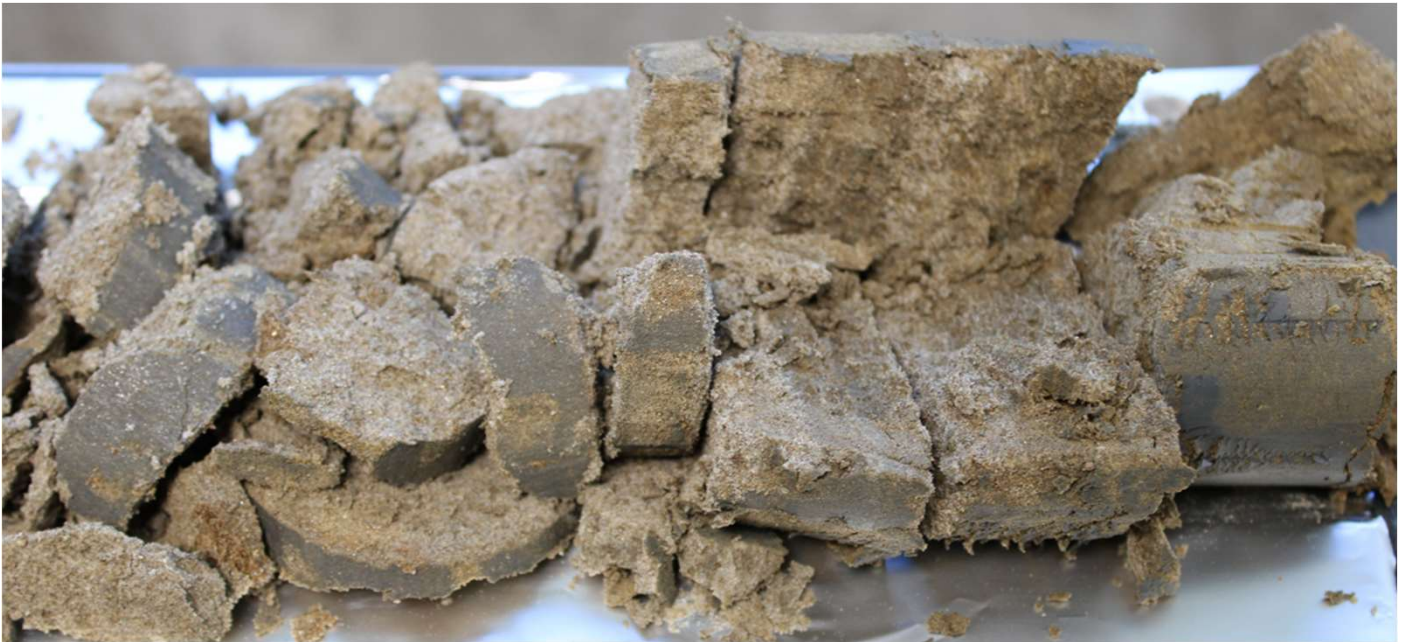
5 – 5,4m - Kort, forstyrret prøve. Kornfordeling: Siltig sand
