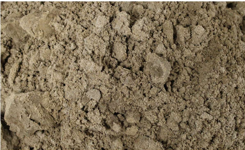
5 – 5,4m - Kort, forstyrret prøve. Kornfordeling: Siltig sand
