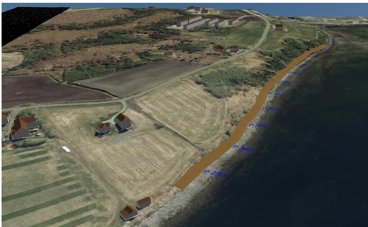
Figur 5: Illustrasjon av erosjonssikringen etter tiltaket er ferdigstilt.
