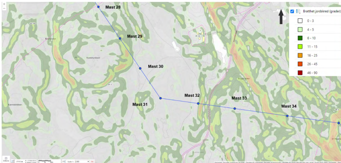
Figur 10 NVE Atlas viser bratthetskart for mast 28 - 34
