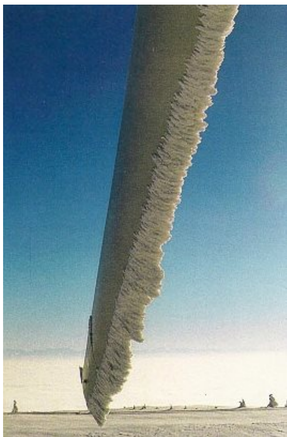
Figur 1-1 Ising på vindturbinblad i Finland. Bildet er gjengitt med tillatelse fra Finsk Meteorologisk Institutt.
