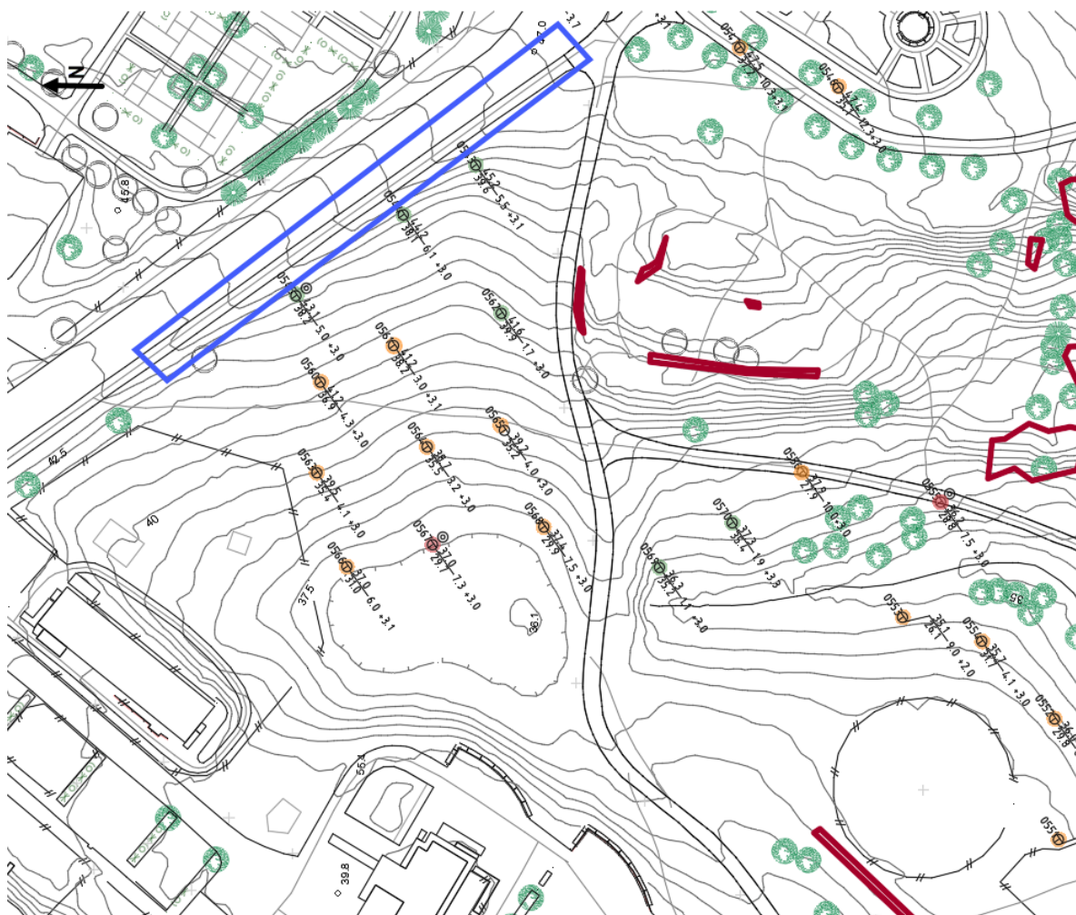
Figur 4-4: Utsnitt av borplan for borerer ved bussholdeplass, markert innenfor blått område. Rød: påvist sprøbrudd, oransje: antatt sprøbruddmateriale og grønn: antatt leire/friksjonsmateriale.
