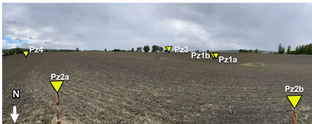
Figur 4-9 Omtrentlig plassering av poretrykksmålere.
