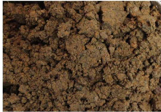
Sjakt F: Sandig, grusig, siltig materiale Vanninnhold: 12,7%, Telegruppe: T3
