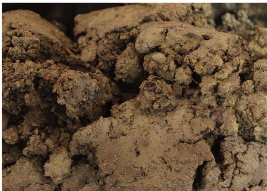
H: 0,3 – 0,7m: Sandig siltig grusig materiale
