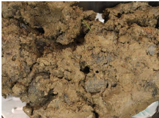
Sjakt G: Sandig, siltig, grusig materiale Vanninnhold: 14,2%, Telegruppe: T3
