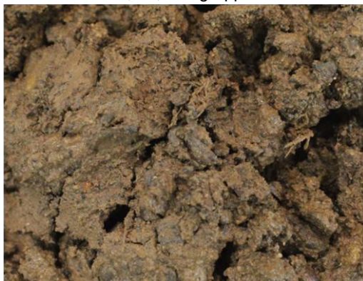
Sjakt J: Sandig grusig materiale Vanninnhold: 13,8%, Telegruppe: T2
