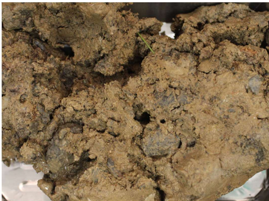
G: 0,3 – 1,5m: Sandig siltig grusig materiale
