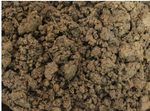
Sjakt E: Sandig, siltig, grusig materiale Vanninnhold: 10,3%, Telegruppe: T3
