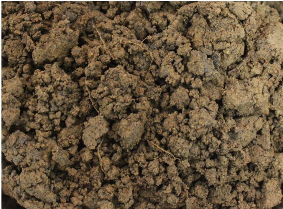
E: 0,1 – 1m: Sandig siltig grusig materiale
