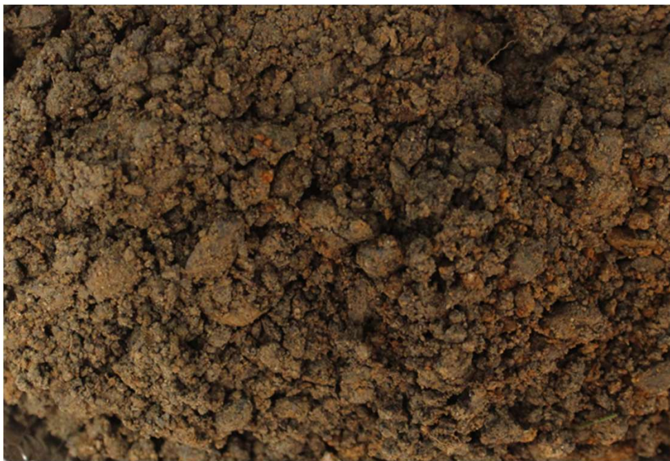
C: 0,6 – 2m: Sandig grusig siltig materiale
