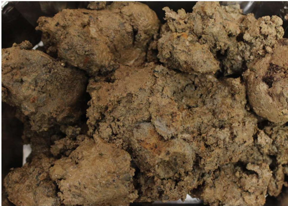
A: 0,5 – 2m: Sandig grusig siltig materiale
