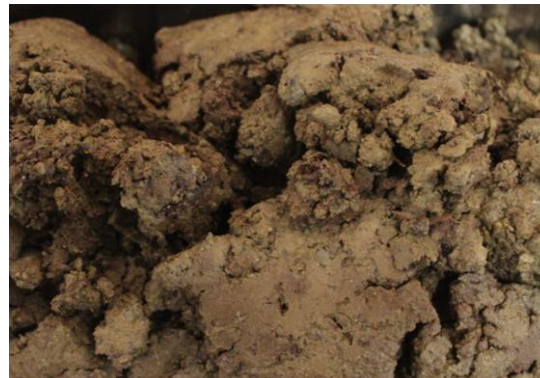
Sjakt H: Sandig, siltig, grusig materiale Vanninnhold: 22,4%, Telegruppe: T3
