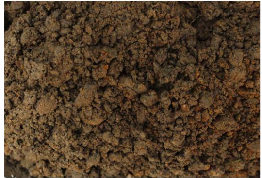
Sjakt C: Sandig, grusig, siltig materiale Vanninnhold: 8,9%, Telegruppe: T2
