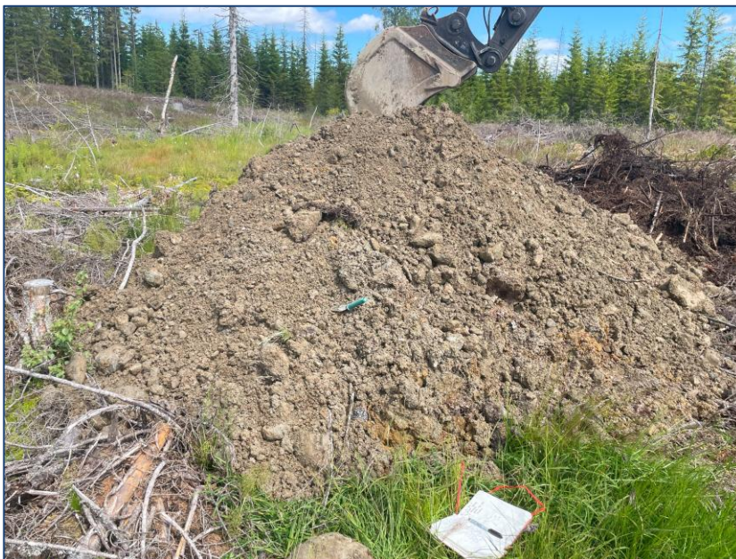
Figur 5.2 Massene består hovedsakelig av sand, grus og stein. Kilde: VSO Consulting, 2025.
