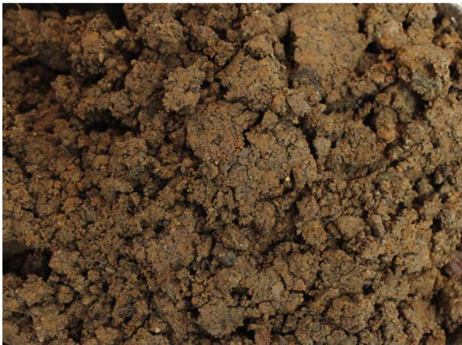
F: 0,5 – 2m: Sandig grusig siltig materiale
