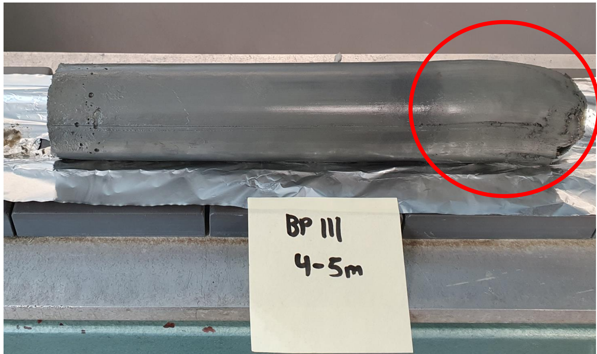
Figur 6-12: Bilde av sylinderprøve i borpunkt 111 [9]. Området hvor sprøbruddmateriale er registrert er vist med rød sirkel.
