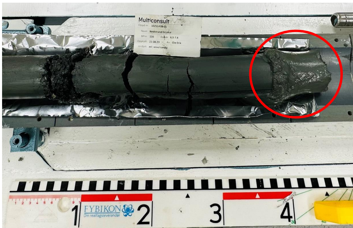
Figur 6-13: Bilde av sylinderprøve i borpunkt 116 [9]. Området hvor sprøbruddmateriale er registrert er vist med rød sirkel.
