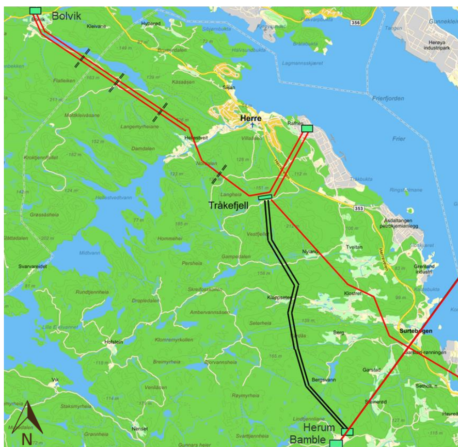
Figur 1-1: Foreslått lokasjon av ny transformatorstasjon, markert med grønt rektangel ved Tråkefjell, og tilhørende ledningsnett. Nye ledninger mellom Herum og Frier transformatorstasjon vises som svart dobbeltlinje. Eksisterende nett vises som rød linje. Tiltaksområdet ligger vest for Frierfjorden i Bamble kommune, Telemark fylke.
