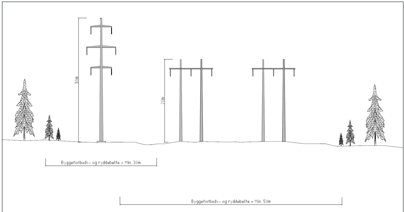
Figur 14: Skisse som viser forskjell i utforming og ryddebelte for de to alternative mastekonfigurasjonene som vurderes. Vertikalopphegt dobbeltkursmast vises til venstre og parallelførte enkeltkursmaster vises til høyre. Arealbeslag for to parallelførte enkeltmaster er tidligere vurdert i rapporten.
