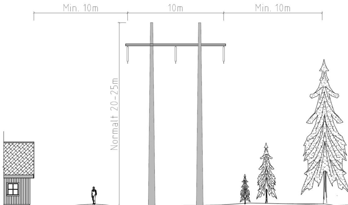
Figur 2: Mastebilde. H-mast av kompositt eller stål planlegges benyttet på store deler av strekningene. Rydde- og byggeforbudsbeltet er 30 meter.
