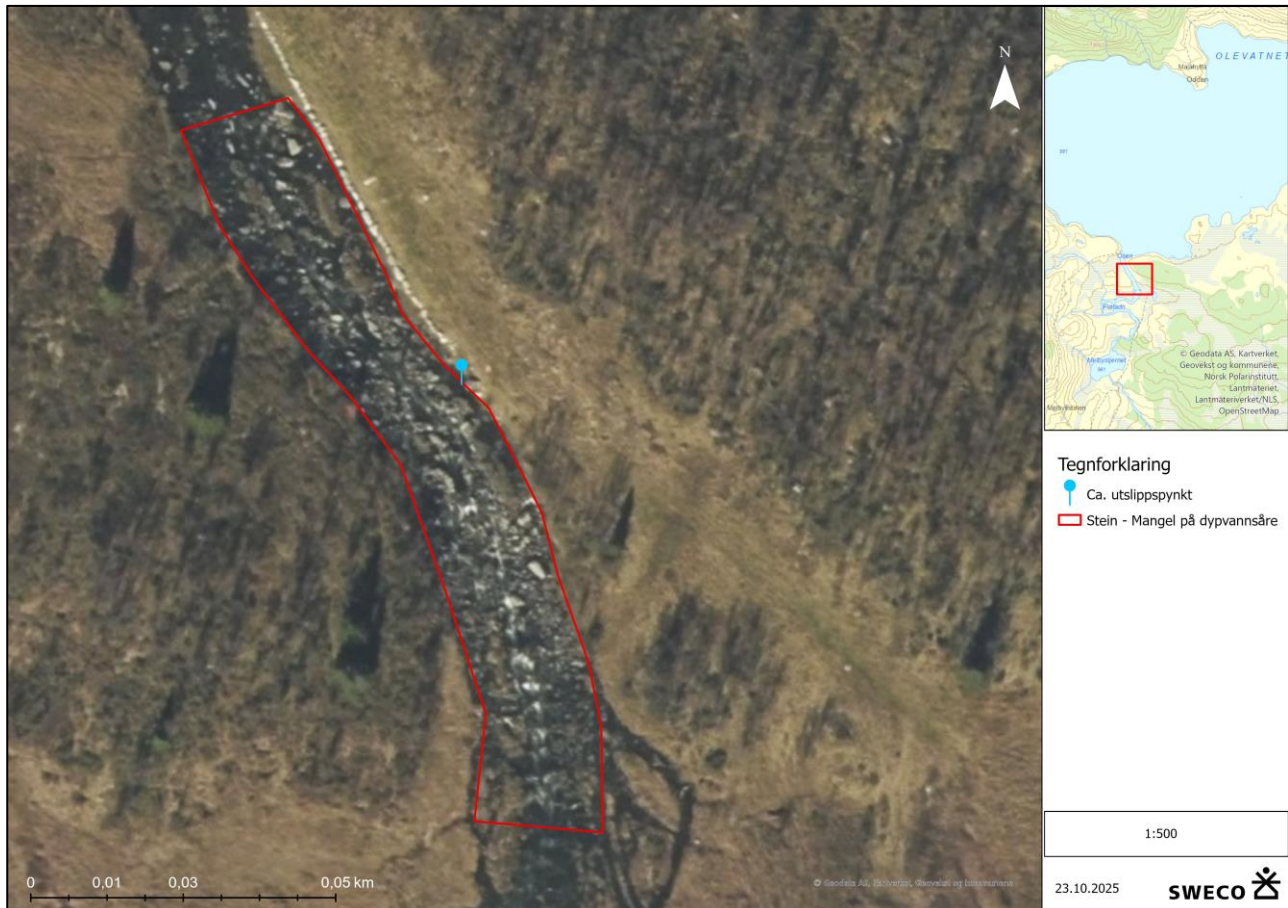
Figur 5. Partiet innenfor rød markering består av mye grov stein og ingen god djupål som kan utbedre fiskevandring ved liten vannføring.
