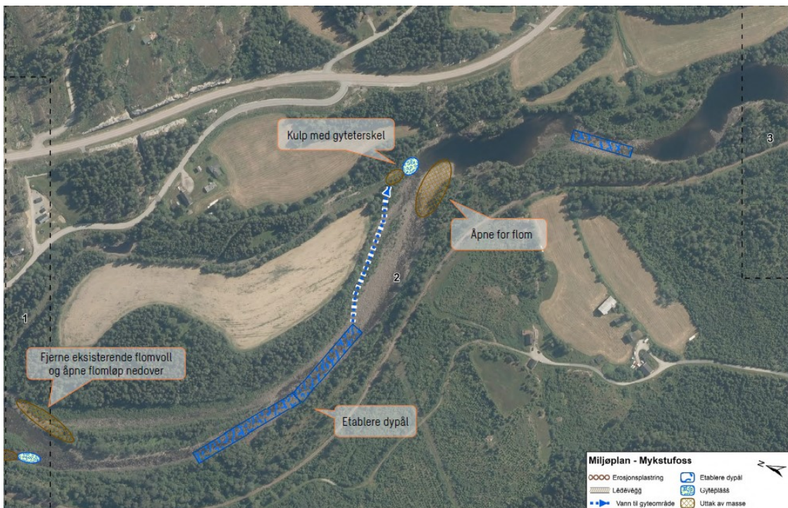
Figur 14. Eksempel på tiltak på deler av strekningen mellom Kjerredammen og Mykstufofossen (kilde:Miljøplan Glitre). Bredden på elveløpet varierer fra ca. 25 m til over 70 m.
