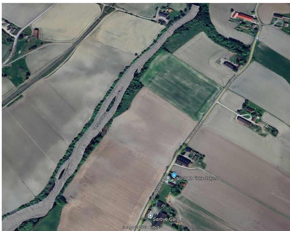
Figur 2.5 Kartlegging av elvebunn i Vestfosselva utført av Field Group i mai 2023 viste ingen erosjonsgroper inn mot kvikkleiresonen Smørgrav-Vålen (bakgrunnskart Google Earth).
