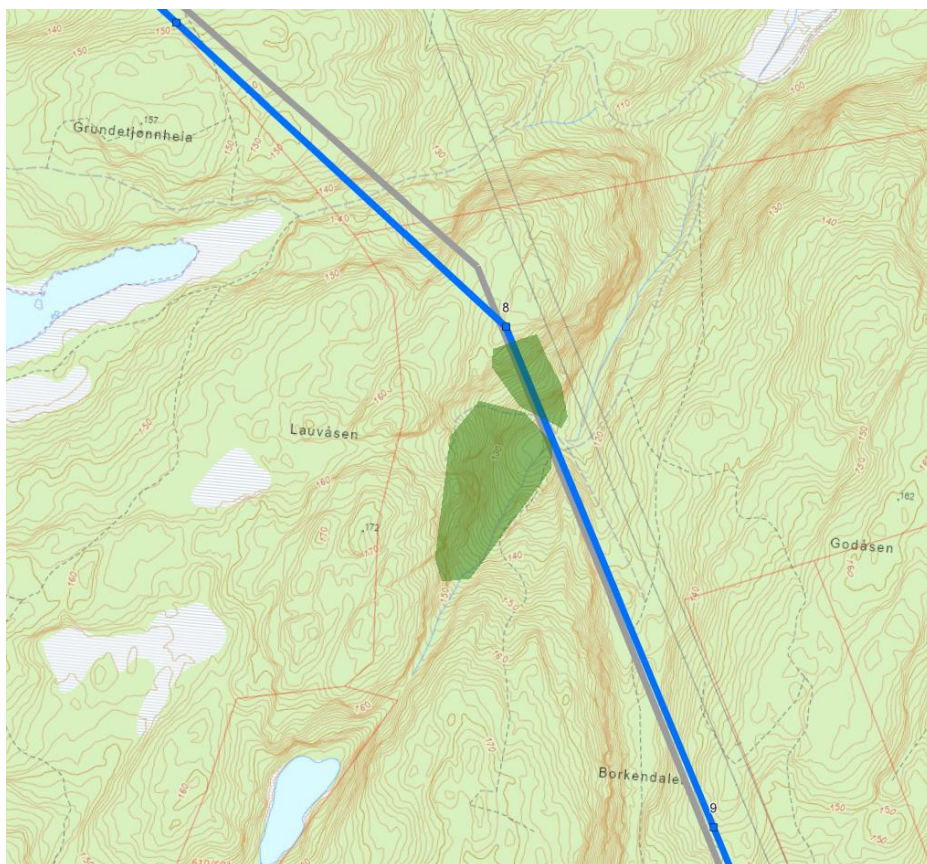
Figur 3-1. Konsesjonsgitt trase vist med grå farge. Detaljprosjektert trase og mastepunkt vist med blå farge. Skravert område er ryddebelte langs ledningen. De to naturtypelokalitetene fra konsekvensutredningen er vist med grønn farge. Eiendomsgrenser vist med tynn rød strek.
