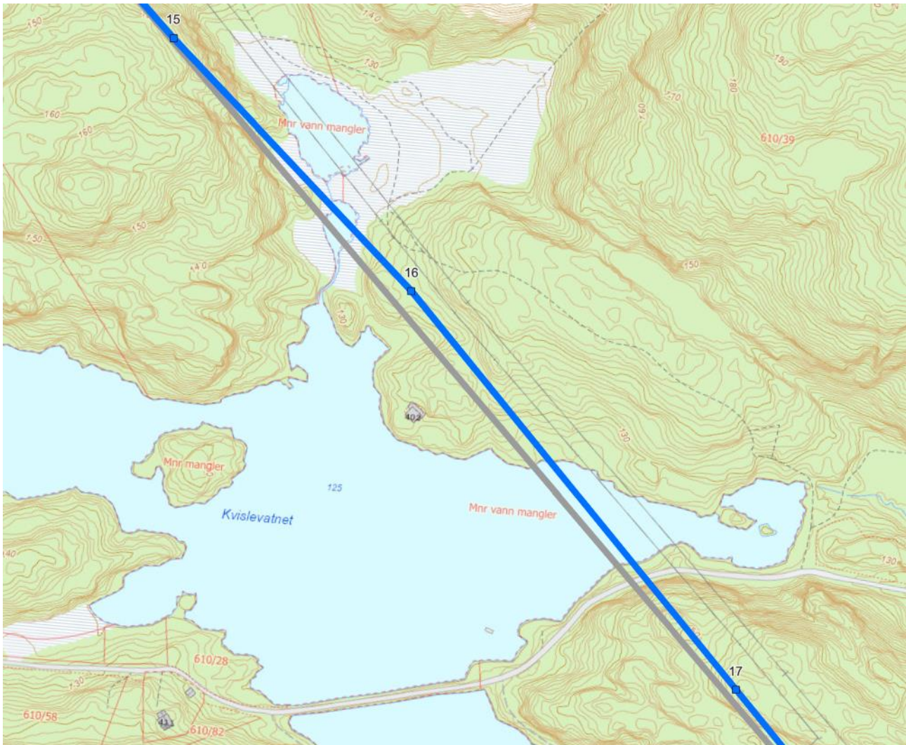
Figur 3-2. Konsesjonsgitt trase vist med grå farge. Detaljprosjektert trase og mastepunkter er vist med blå farge.
