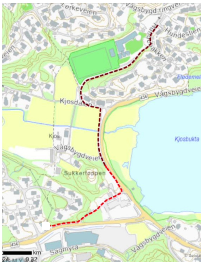
Figur 1: Konsesjonsgitt trase for jordkabel (2016-2046).
