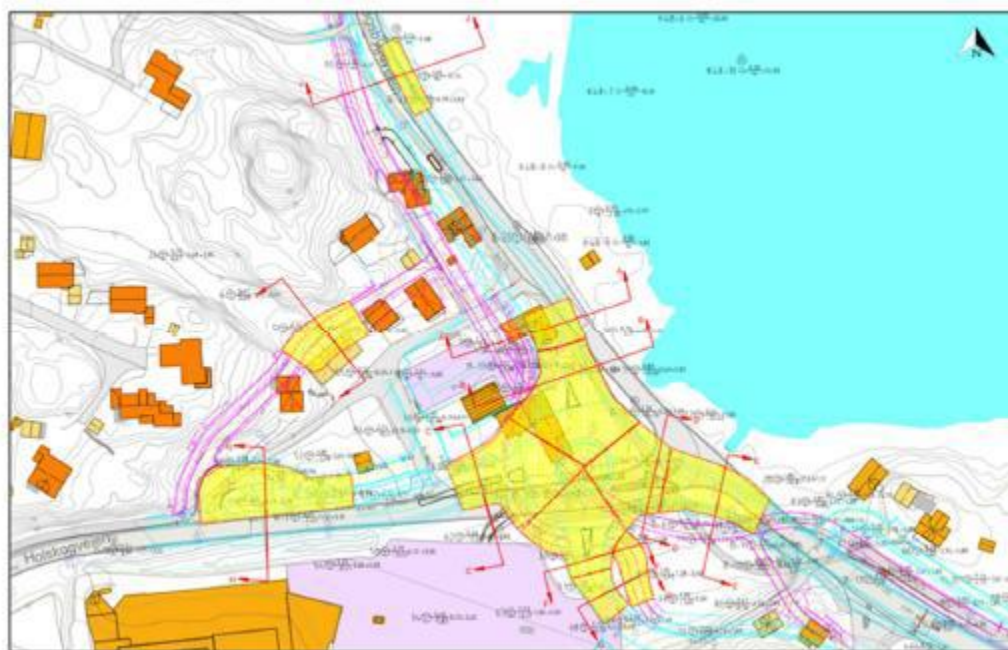
Figur 14: Oversikt over områder (markert med gul farge) for tiltak med lette fyllmasser. Hentet fra Geoteknisk prosjekteringsrapport AFRY som er vedlagt.
