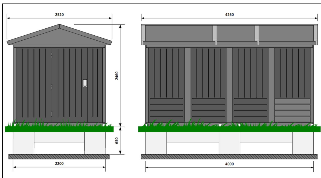
Figur 2 - Dimensjoner av nettstasjon på Måsøyval.
