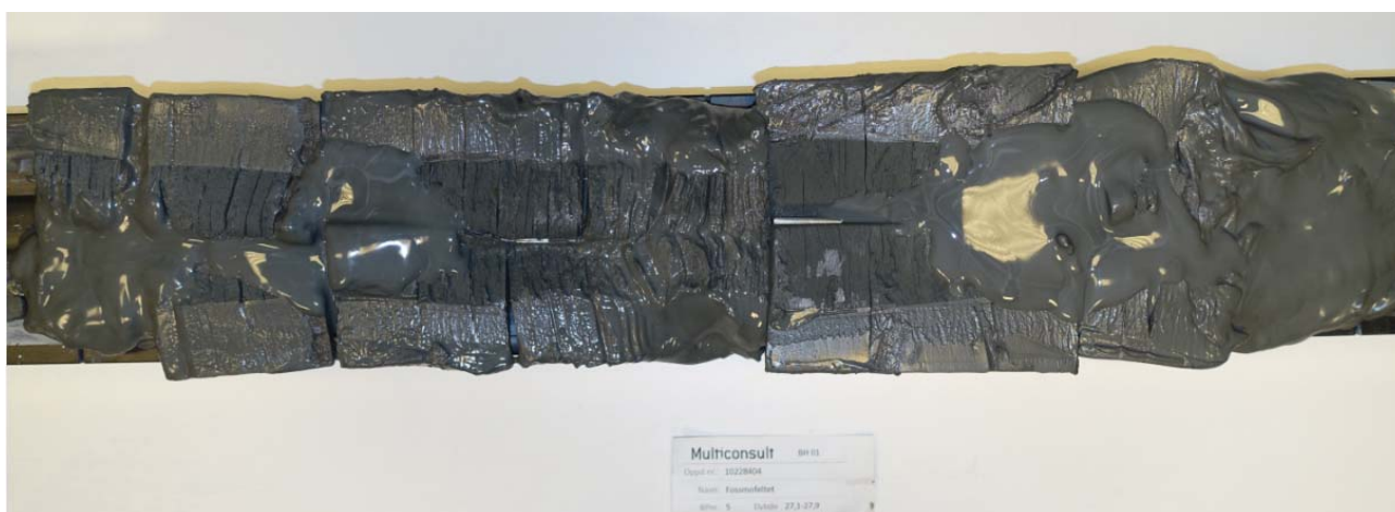
Figur 4-3: Siltig kvikkleire fra borpunkt 5, dybde 27,1-27,9 m.
