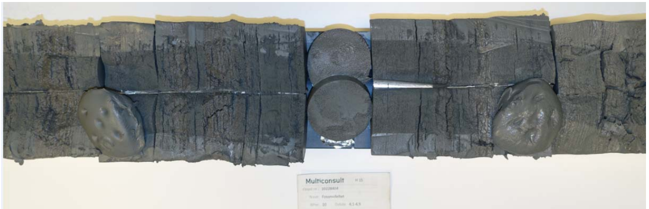
Figur 4-4: Siltig, sandig leire fra borpunkt 10, dybde 4,1-4,9 m. Lagdelt materiale.
