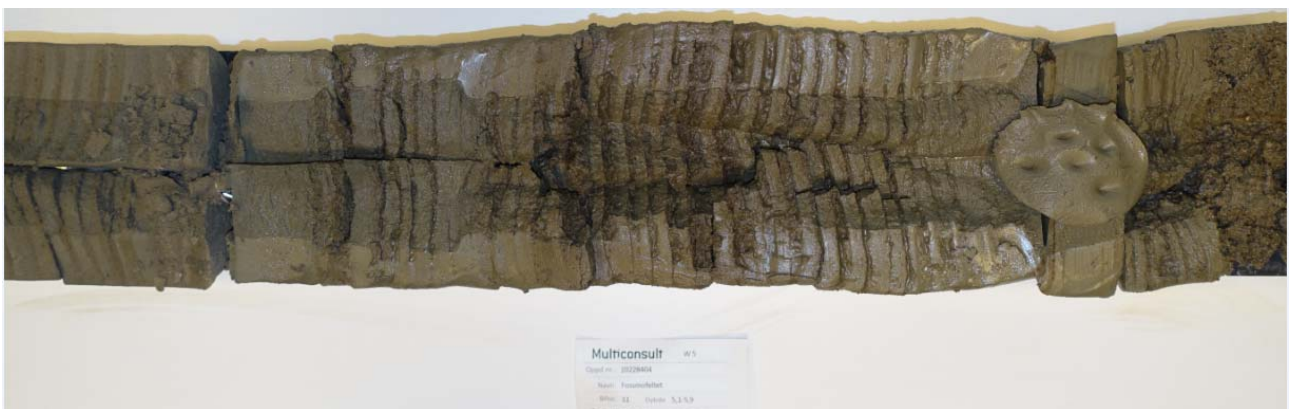
Figur 4-5: Sandig, leirig silt fra borpunkt 11, 5,1-5,9 m dybde. Tydelig lagdeling.
