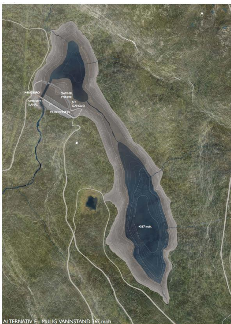
Figur 2. Visualisering av nytt vanddekt areal ved damriving. Beregning av vanddekt areal er interpolert fra kart med fem-meters koter og må anses som grove. Illustrasjonen viser alternativ E der kun fyllingsdam fjernes.
