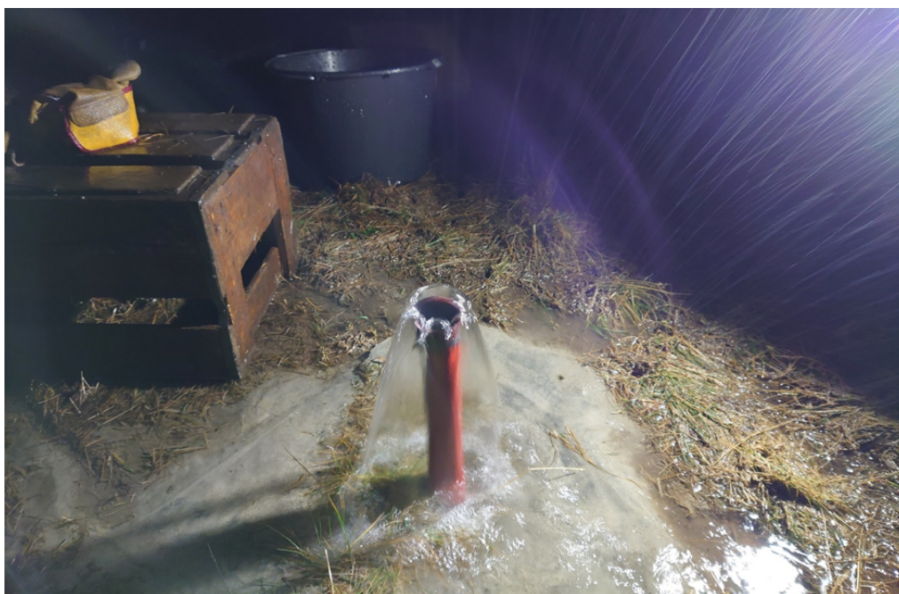
Figur 2-6. Ub-1: Artesisk reaksjon (0,5 l/s) med sandspiss/filter fra 16,3-17,8m, 2 l/s ved pumping (AV nov-21)
