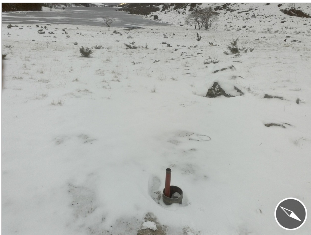
Figur 25. Ub-1: Artesisk reaksjon (0,5 l/s) med sandspiss/filter fra 16,3-17,8 meter. Ga 2 l/s ved pumping.
