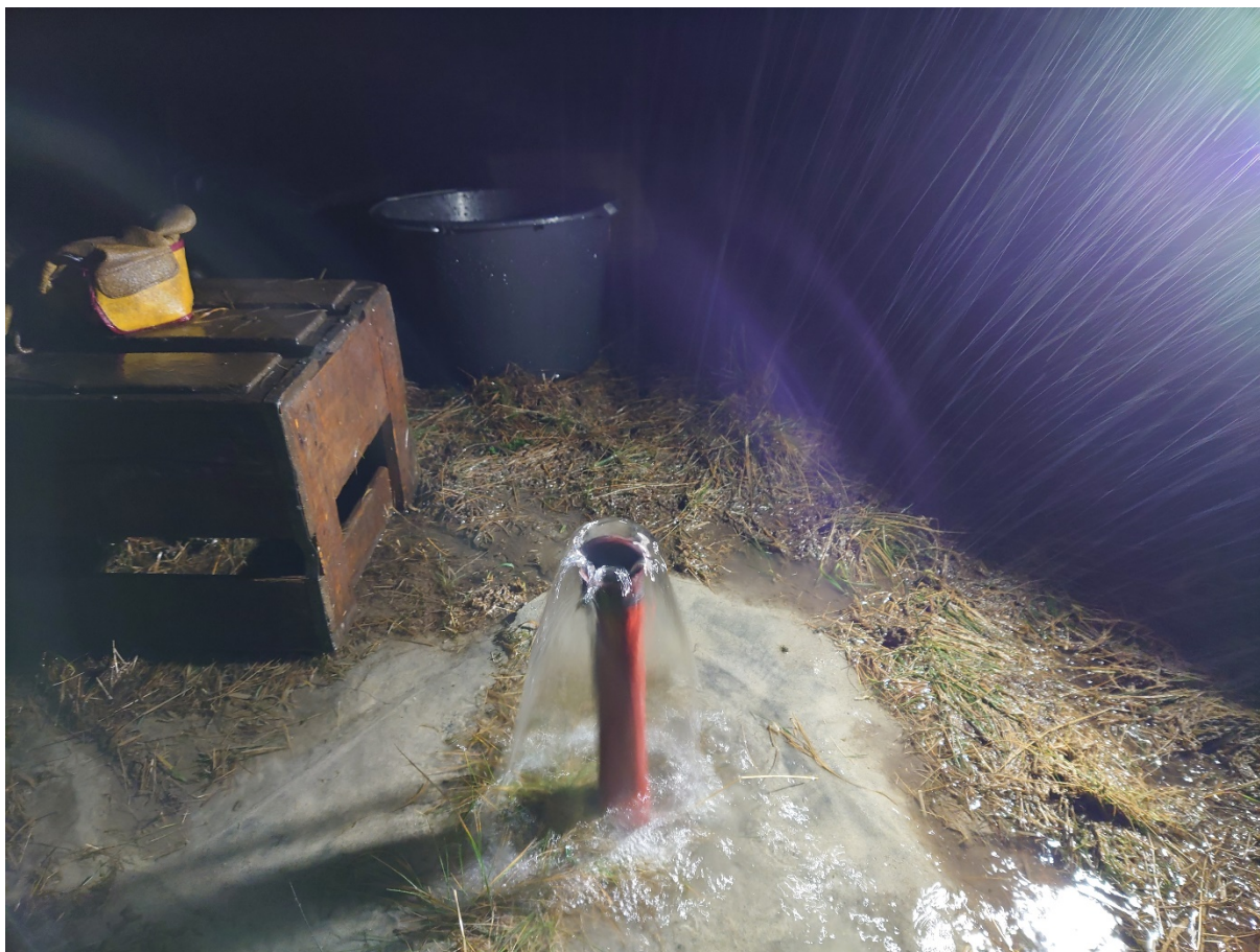
Figur 25. Ub-1: Artesisk reaksjon (0,5 l/s) med sandspiss/filter fra 16,3-17,8 meter. Ga 2 l/s ved pumping.
