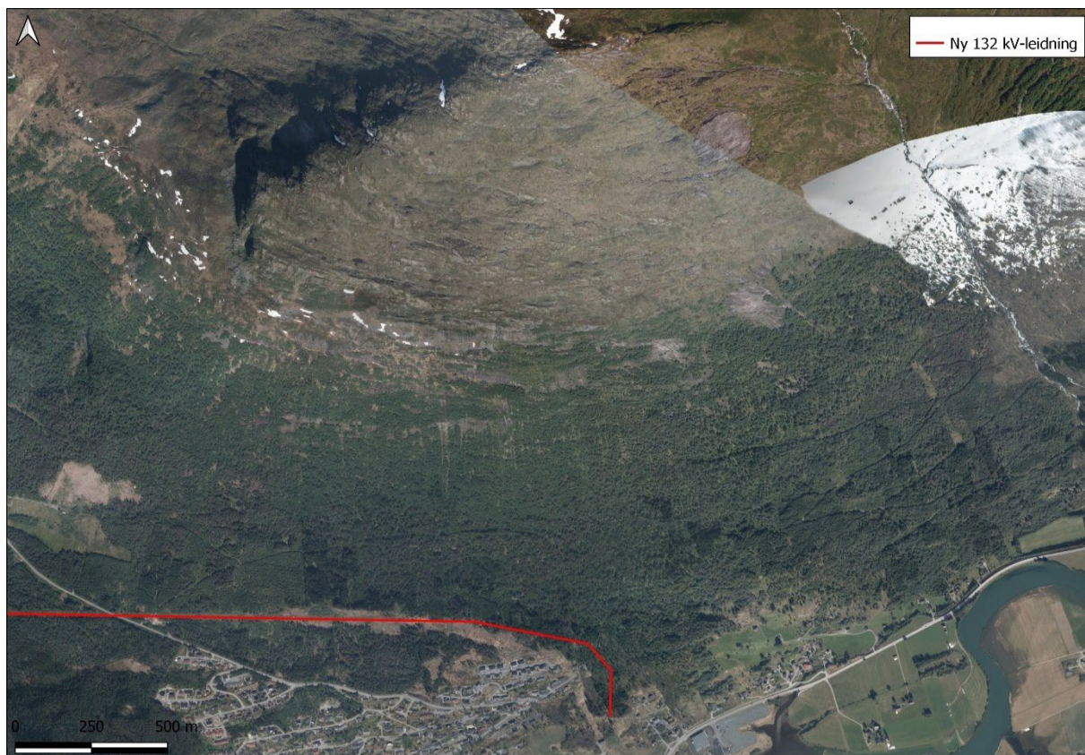
Figur 18: Flyfoto frå 2020 ved austlege del av trase under fjellsida opp mot Gryta (1032 moh.). Det er fleire striper i skogen som indikerer skredspor. Kjelde: Geodata WMS.
