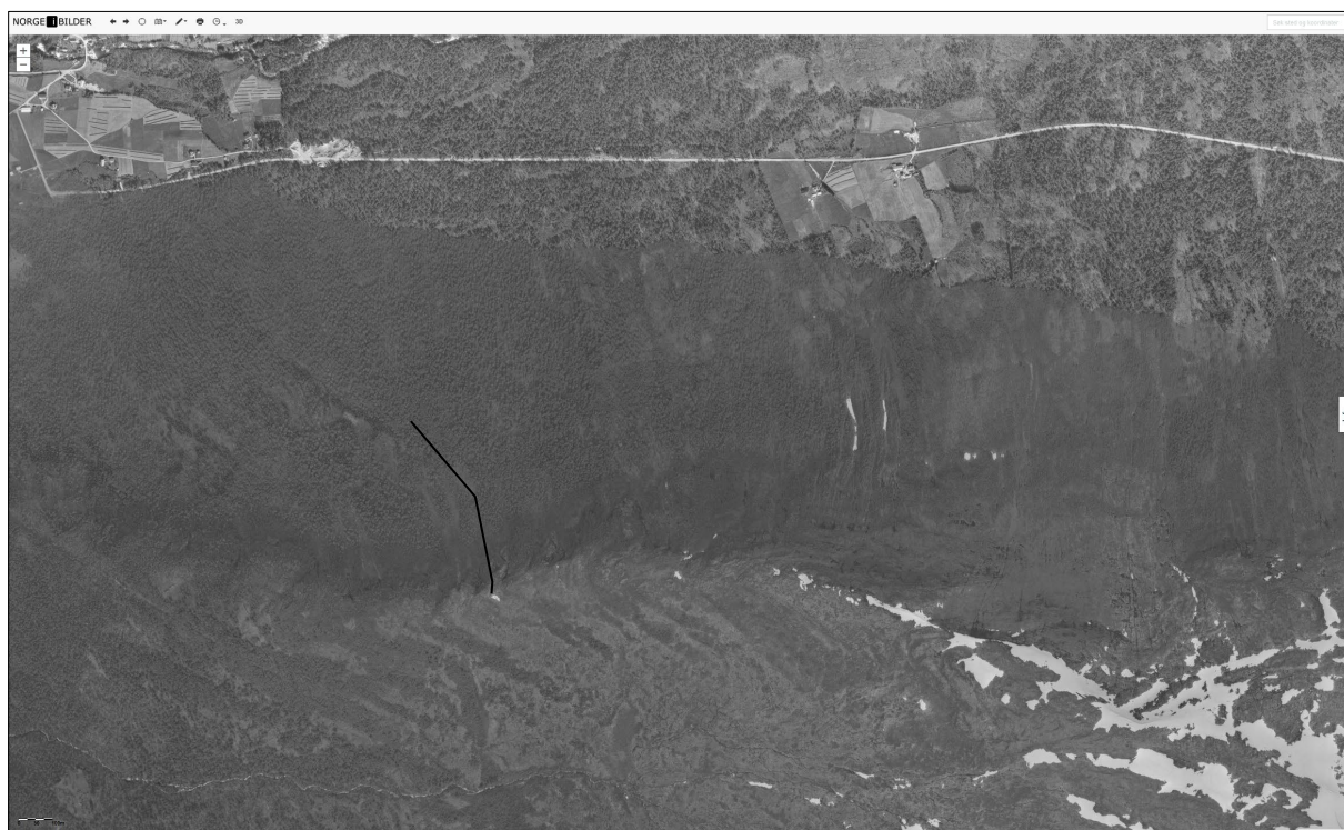
Figur 19: Flyfoto frå 1967 ved Olaskora viser skredspor frå snøskred tett på traseen. Traseen er teikna inn med svart strek der den er tett på skredspora. M69 og M70 er ca. 50 m aust/nord aust for skredsporet. Vertikalfoto: norgebilder.no
