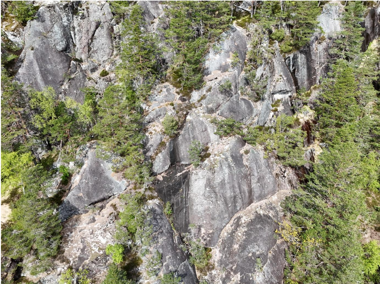
Figur 9: Eksempel på den isskurte bergmassen med lav løsnese sannsynlighet. Bildet er tatt fra drone mot nord ovafor de østre delene av kartleggingsområdet.
