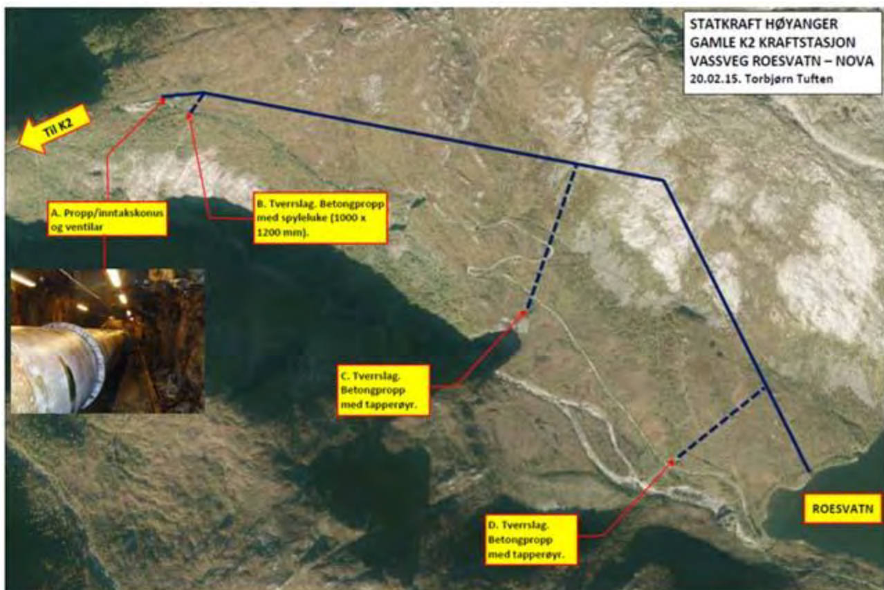
Figur 4-9 Tunnel mellom Roesvatn og Nova. Inntak ved Nova og tverrslag støpes igjen
