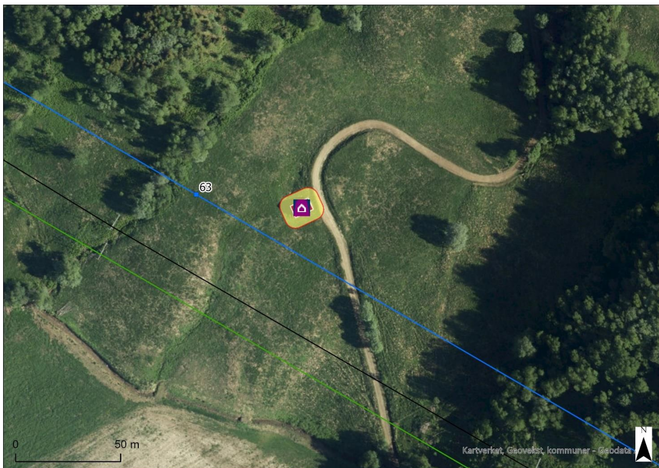
Figur 3-3. Storflåten gårdstun er fredet. Mast 63 (blå prikk) blir stående ca. 40 meter fra bygningen. Veien forbi gårdstunet er aktuelle å bruke i forbindelse med ledningsbyggingen. Blå strek trase for ny 132 kV-ledning. Sort strek eksisterende ledning. Grønn strek eksisterende ledning som skal rives.
