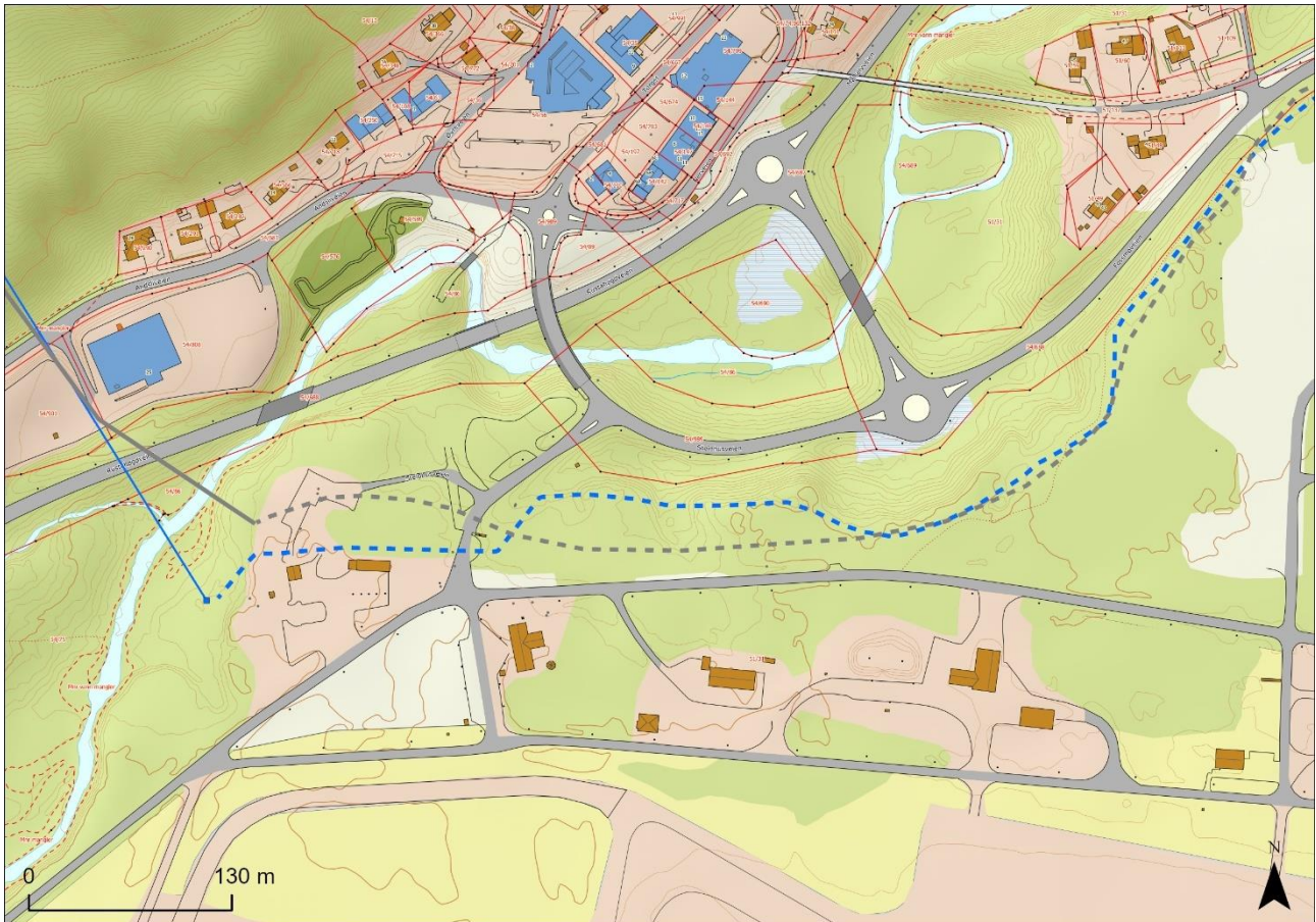
Figur 2-4. Konesjongsjitt trase vist med grå strek. Ny kabeltrase vist med blå strek.
