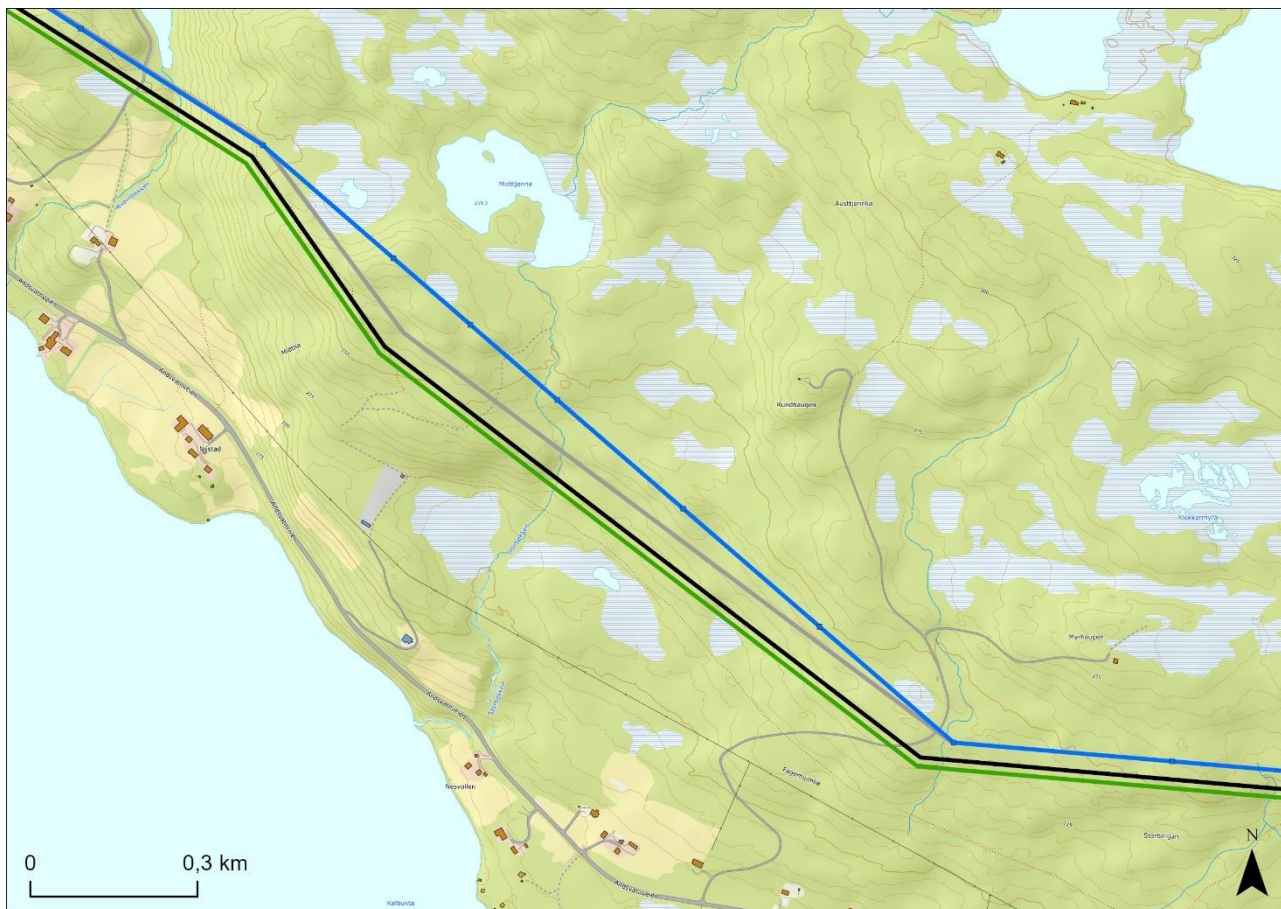
Figur 2-6. Kongsjongsjitt trase vist med grå strek. Ny ledningstrase vist med blå strek. Sort strek eksisterende ledning. Grøn strek eksisterende ledning som skal rives.
