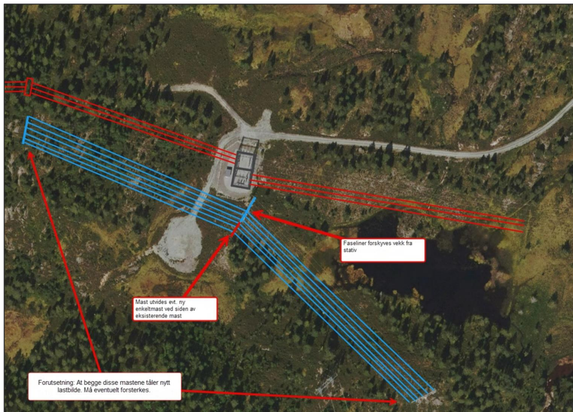
Figur 4-6: Alternative løsninger for omkobling av ny 132 kV ledning Brøkke-Bjørgedalen til eksisterende 132 kv ledning Bjørgedalen-Einangsmoen, ved Bjørgedalen koblingsstasjon.
